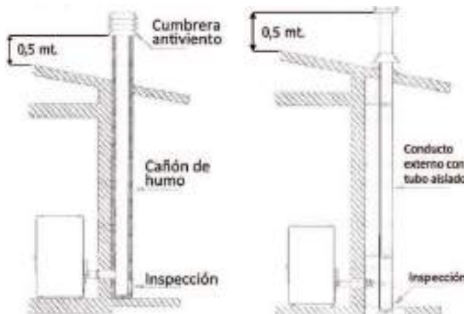
Fig. 2: conexión con el cañón de humo
