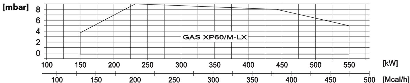
Fig. 2 X = Caudal Y = Presión en la cámara de combustión
