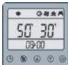
Modo de aire acondicionado (incluido el modo de calefacción y el modo de enfriamiento), la temperatura en el lado izquierdo del control alámbrico es la temperatura establecida del ambiente interior (calefacción o enfriamiento), y en el lado derecho es la temperatura real de la entrada de agua.
