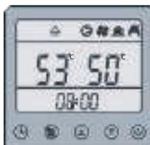
En el modo de agua caliente, la temperatura en el lado izquierdo del control alámbrico es la temperatura establecida del tanque de agua caliente, y en el lado derecho es la temperatura real del tanque de agua caliente.
